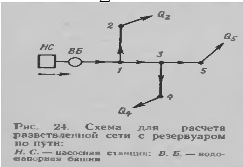
Точка 2 — диктующая, которая требует водонапорную башню наибольшей высоты. Принимаем высоту водонапорной башни 13,5 м.
