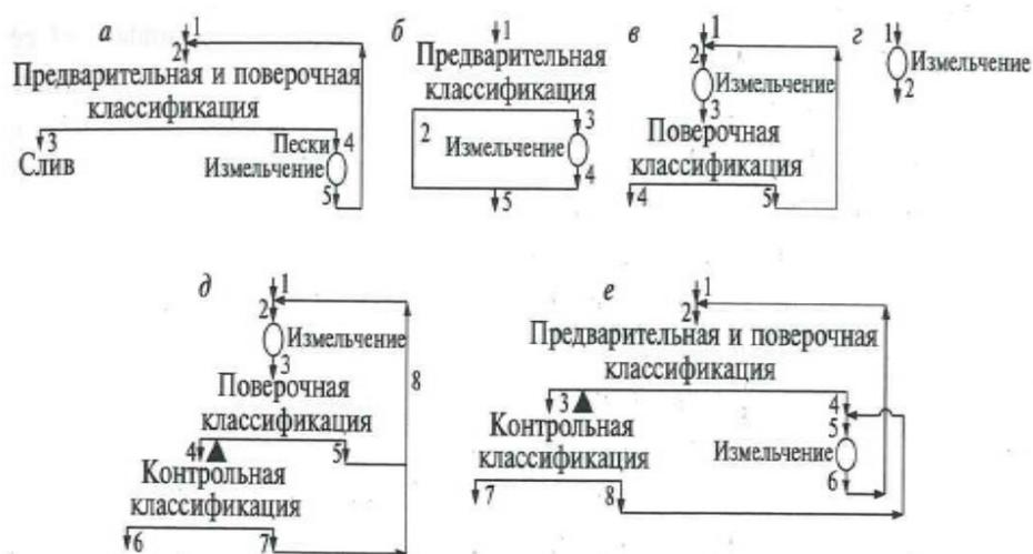
Рис. 3.10. Одностадиальные схемы измельчения
