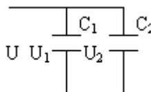
3. Между клеммами А и В включены конденсаторы, значения емкостей которых показаны на рисунке. Вычислите емкость С системы.
