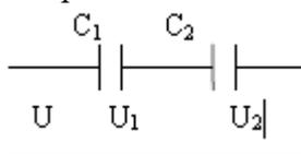
2. Как определить эквивалентную емкость при данном виде соединения Конденсаторов?
