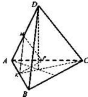
Построение: 1)  $MK \parallel DB$ ,  $MP \parallel DC$  (по свойству секущей плоскости). Значит,  $(MKP)$  - искомое сечение.
