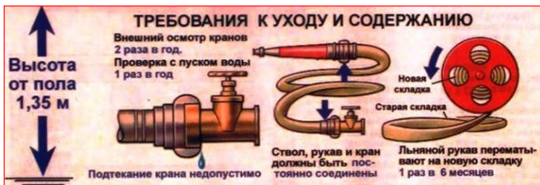
Рисунок 3.4 – Требования к уходу и содержанию внутреннего пожарного крана
