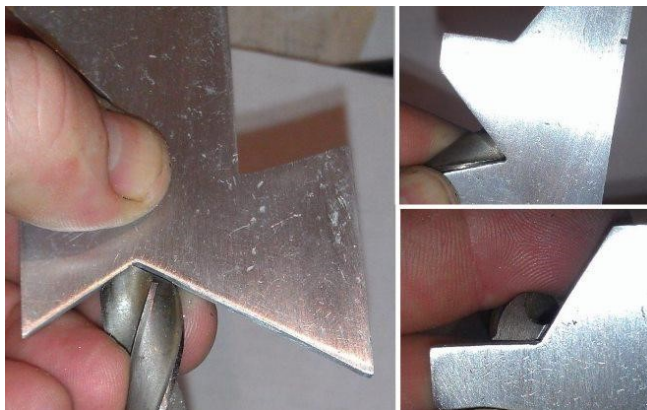
Рисунок 3 - Проверка углов заточки с помощью шаблона
