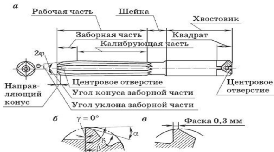
Рис. 9.61. Ручная развертка: а — конструкция; б, в — геометрия
