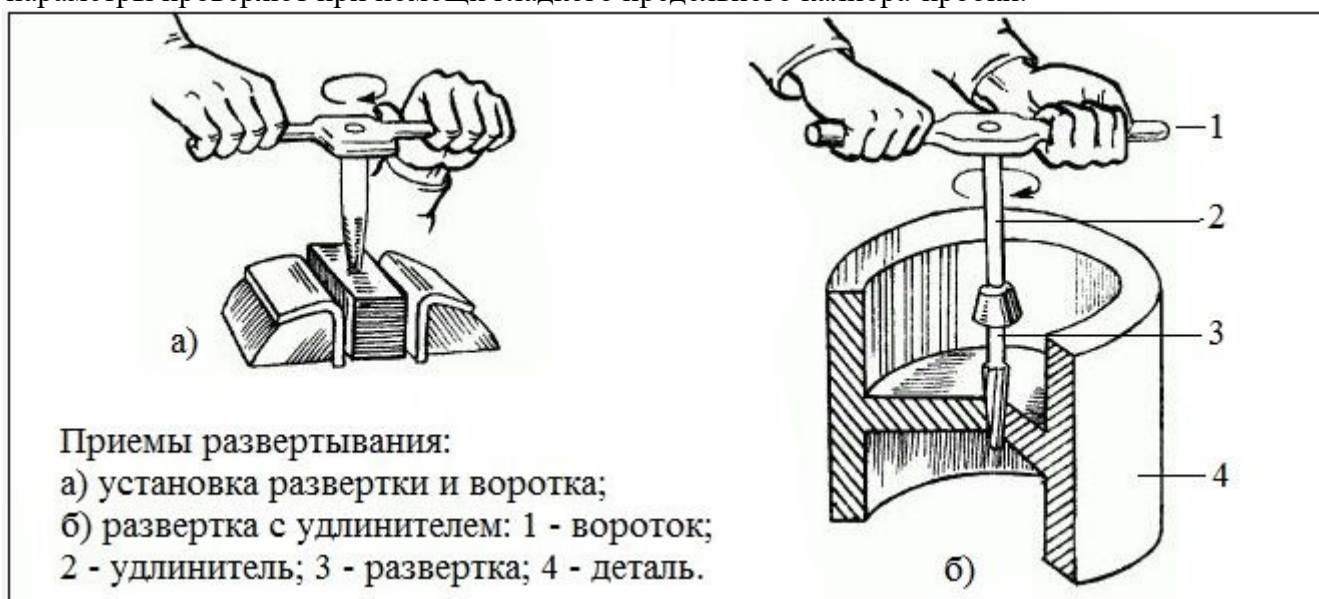
Приемы ручного развертывания
