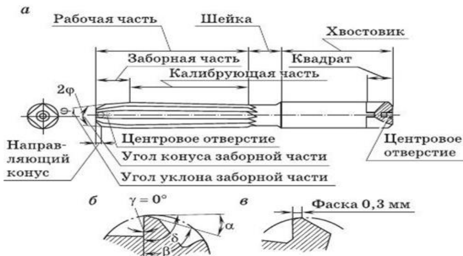
Рис. 9.61. Ручная развертка: а — конструкция; б, в — геометрия
