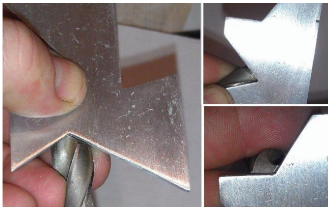
Рисунок 3 - Проверка углов заточки с помощью шаблона
