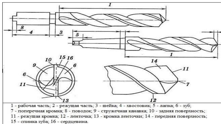
Рисунок 1 - Конструктивные элементы спирального сверла
