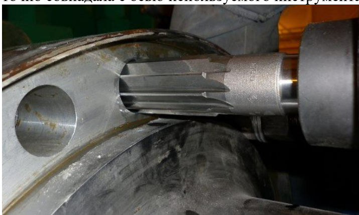
Обработка отверстия на станке твердосплавной разверткой
