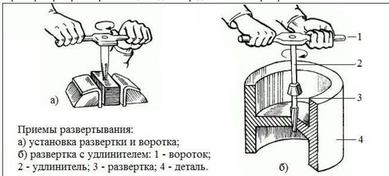
Приемы ручного развертывания
