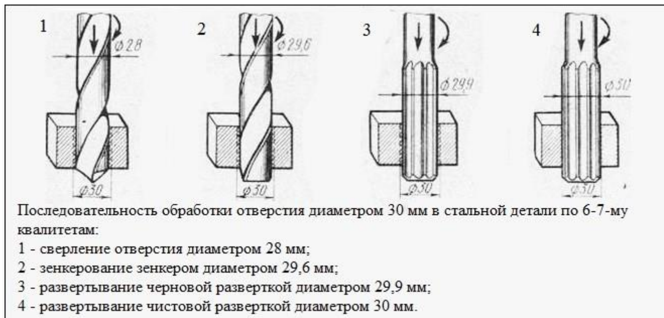
Последовательность обработки цилиндрических отверстий
