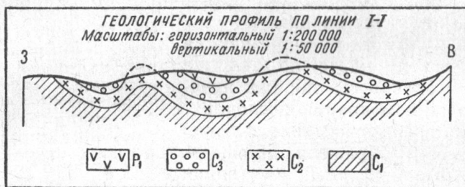
Рис. 48. Принцип построения геологического разреза по геологической карте
