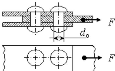
Определить минимальный диаметр заклепки  $d_0$  из расчета на срез и наименьшую толщину соединяемых пластин  $\delta$  из расчета на смятие для соединения, показанного на рисунке, если на него действует сила  $F$ .
