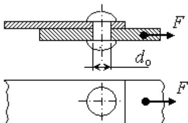
Определить допускаемую силу  $F$  из расчета на срез и наименьшую толщину соединяемых пластин  $\delta$  из расчета на смятие для соединения, показанного на рисунке, если диаметр заклепки  $d_0$ .
