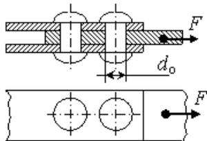
Определить допускаемую силу  $F$  из расчета на срез и наименьшую толщину соединяемых пластин  $\delta$  из расчета на смятие для соединения, показанного на рисунке, если диаметр заклепки  $d_o$ .
