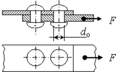
Определить минимальный диаметр заклепки  $d_o$  из расчета на срез и наименьшую толщину соединяемых пластин  $\delta$  из расчета на смятие для соединения, показанного на рисунке, если на него действует сила  $F$ .
