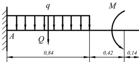
Строить эпюры в консольной балке с жесткой заделкой можно двумя способами — обычным, предварительно определив опорные реакции, и без определения опорных реакций, если рассматривать участки, идя от свободного конца балки и отбрасывая левую часть с заделкой. Построим эпюры обычным способом.
