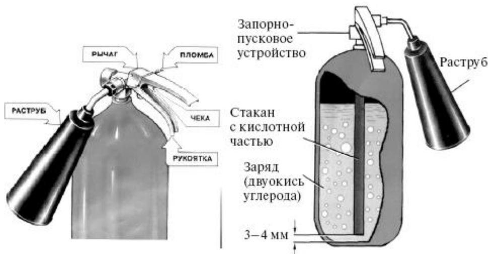
Чтобы привести огнетушитель в действие, необходимо сорвать пломбу, выдернуть чеку, перевести раструб в горизонтальное положение и нажать на рычаг, а затем направить струю заряда на огонь. При работе углекислотного огнетушителя нельзя касаться раструба, так как температура его за счет испарения жидкого углекислого газа понижается до  $-70\text{ }^{\circ}\text{C}$ . В случае попадания пены в глаза их следует промыть чистой водой или 2 %-ным раствором борной кислоты.
