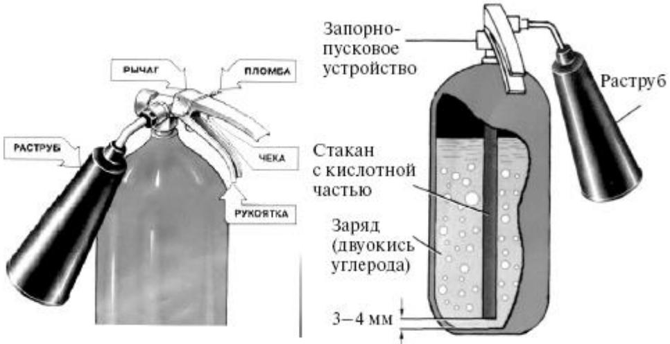
Чтобы привести огнетушитель в действие, необходимо сорвать пломбу, выдернуть чеку, перевести раструб в горизонтальное положение и нажать на рычаг, а затем направить струю заряда на огонь. При работе углекислотного огнетушителя нельзя касаться раstruba, так как температура его за счет испарения жидкого углекислого газа понижается до  $-70^{\circ}\text{C}$ . В случае попадания пены в глаза их следует промыть чистой водой или 2 %-ным раствором борной кислоты.
