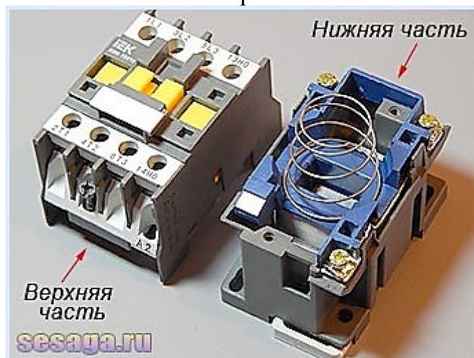
Рис. 6 Устройство магнитного пускателя
