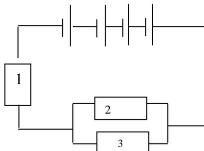
26) К резистору, подключена батарея из элементов. Определить силу тока в резистору, если  $\varepsilon_1 = 8 \text{ В}$ ,  $r_1 = 1 \text{ Ом}$ ,  $\varepsilon_2 = 4 \text{ В}$ ,  $r_2 = 0,5 \text{ Ом}$ ,  $R = 5 \text{ Ом}$ .
