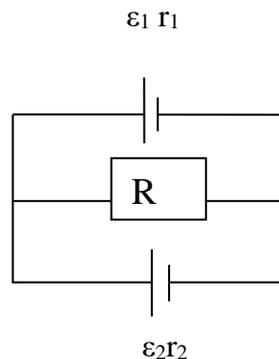
28) Два источника тока с  $\varepsilon_1 = 2 \text{ В}$  и  $\varepsilon_2 = 1,5 \text{ В}$  и внутренними сопротивлениями  $r_1 = 0,5 \text{ Ом}$  и  $r_2 = 0,4 \text{ Ом}$ , включены параллельно с  $R = 2 \text{ Ом}$ . Определить силу тока через сопротивление R.
