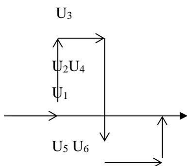
40) Начертить схему цепи, определить полное напряжение в цепи, полное сопротивление, коэффициент мощности и среднюю потребляемую мощность. Напряжения на участках цепи равны соответственно:  $U_1=6$  В,  $U_2=5$  В,  $U_3=4$  В,  $U_4=15$  В,  $U_5=10$  В,  $U_6=10$  В. Сопротивление первого участка цепи 1,5 Ом.
