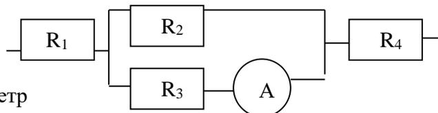
показывает 1 А. Определить значения сил токов на каждом резисторе.
