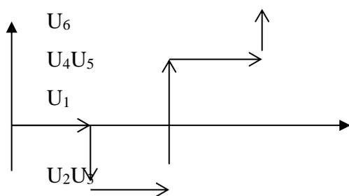
41) Начертить векторную диаграмму цепи, определить полное напряжение в цепи, полное сопротивление, коэффициент мощности и среднюю потребляемую мощность. Напряжения на участках цепи равны соответственно:  $U_1=12$  В,  $U_2=20$  В,  $U_3=15$  В,  $U_4=35$  В,  $U_5=16$  В,  $U_6=25$  В.
