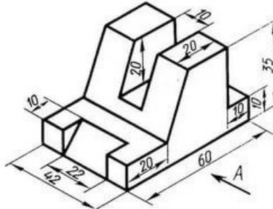
**Задание 13.** По аксонометрической проекции модели построить ее комплексный чертёж
