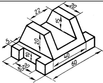
**Задание 12.** По аксонометрической проекции модели построить ее комплексный чертёж
