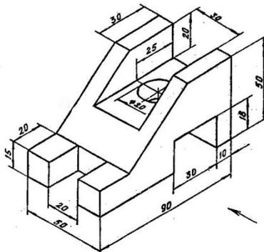
**Задание 15.** По аксонометрической проекции модели построить ее комплексный чертёж
