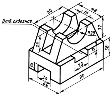
**Задание 10.** По аксонометрической проекции модели построить ее комплексный чертеж
