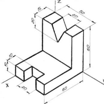
**Задание 14.** По аксонометрической проекции модели построить ее комплексный чертёж
