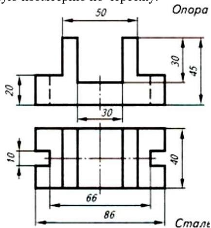
**Задание 9.** По аксонометрической проекции модели построить ее комплексный чертеж
