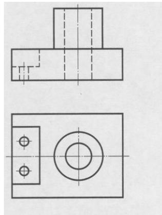
**Задание 21. 3.** По двум проекциям детали построить третью. Нанести на чертеже выносные и размерные линии рациональных размеров.
