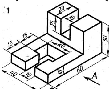
**Задание 11.** По аксонометрической проекции модели построить ее комплексный чертеж
