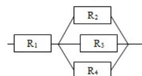
. Четыре проводника соединены по схеме,  $R_1 = 1,6 \text{ Ом}$ ,  $R_2 = 4 \text{ Ом}$ ,  $R_3 = 6 \text{ Ом}$ ,  $R_4 = 12 \text{ Ом}$ . Общее напряжение на резисторах 18 В. Определить общее сопротивление и силу тока в каждом резисторе.
