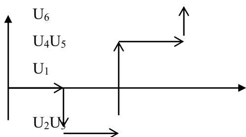
41) Начертить векторную диаграмму цепи, определить полное напряжение в цепи, полное сопротивление, коэффициент мощности и среднюю потребляемую мощность. Напряжение на участках цепи равны соответственно:  $U_1=12$  В,  $U_2=20$  В,  $U_3=15$  В,  $U_4=35$  В,  $U_5=16$  В,  $U_6=25$  В. Сопротивление третьего участка цепи 1,5 Ом.
