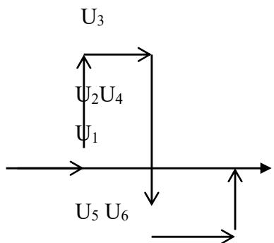
40) Начертить схему цепи, определить полное напряжение в цепи, полное сопротивление, коэффициент мощности и среднюю потребляемую мощность. Напряжение на участках цепи равны соответственно:  $U_1=6$  В,  $U_2=5$  В,  $U_3=4$  В,  $U_4=15$  В,  $U_5=10$  В,  $U_6=10$  В. Сопротивление первого участка цепи 1,5 Ом.
