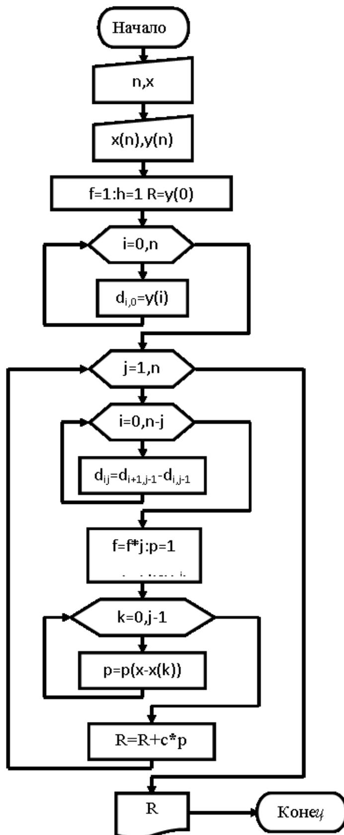
Рисунок.2 – Блок-схема метода Ньютона
