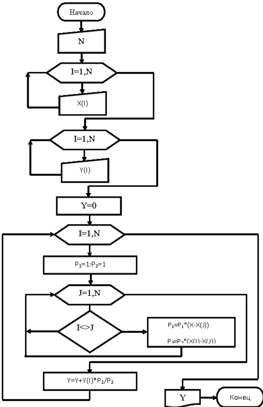
Рисунок 1– Блок-схема метода Лагранжа
