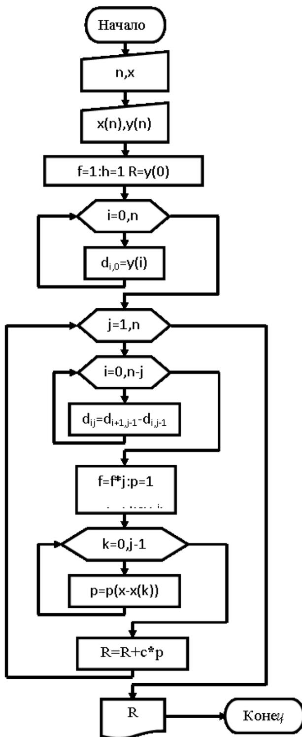
Рисунок.2 – Блок-схема метода Ньютона
