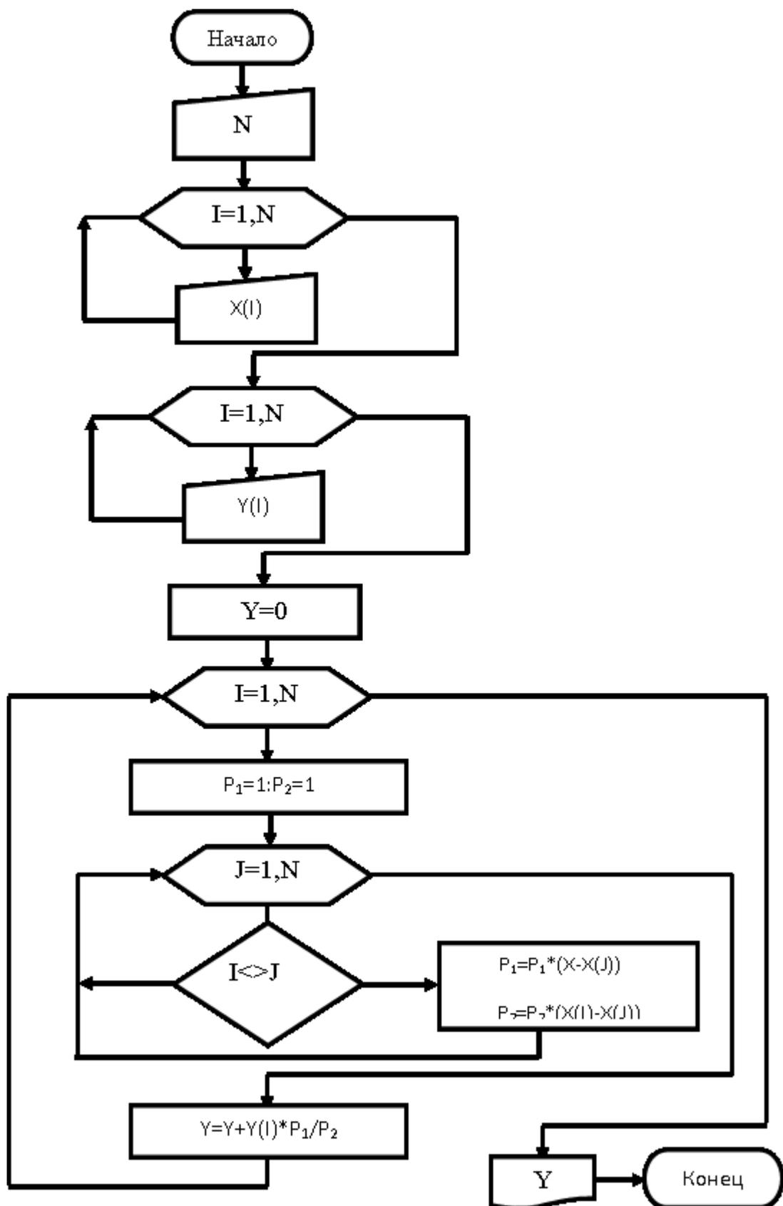
Рисунок 1– Блок-схема метода Лагранжа
