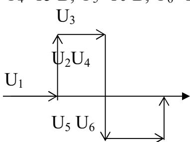
40) Начертить схему цепи, определить полное напряжение в цепи, полное сопротивление, коэффициент мощности и среднюю потребляемую мощность. Напряжение на участках цепи равны соответственно:  $U_1=6$  В,  $U_2=5$  В,  $U_3=4$  В,  $U_4=15$  В,  $U_5=10$  В,  $U_6=10$  В. Сопротивление первого участка цепи 1,5 Ом.
