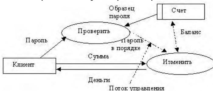
Первым шагом при построении иерархии DFD является построение контекстных диаграмм. Обычно при проектировании относительно простых информационных систем строится единственная контекстная диаграмма со звездобразной топологией, в центре которой находится так называемый главный процесс, соединенный с приемниками и источниками информации, посредством которых с системой взаимодействуют пользователи и другие внешние системы.
