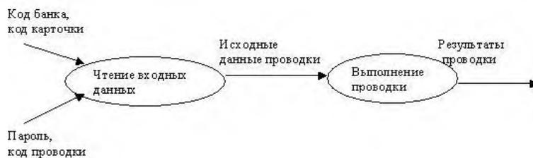
Поток данных соединяет выход объекта (или процесса) с входом другого объекта (или процесса) и представляет собой промежуточные данные вычислений. Поток данных изображается в виде стрелки между производителем и потребителем данных, помеченной именами соответствующих данных. Дуги могут разветвляться или сливаться, что означает соответственно разделение потока данных на части либо слияние объектов.
