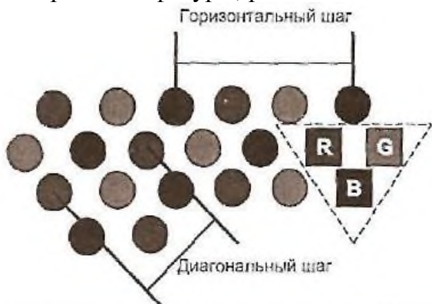
Рис. Монитор. Шаг точки для трубки с теневой маской
