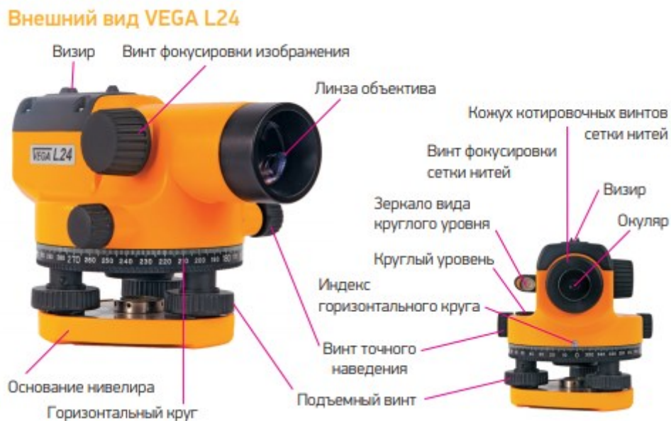
Рисунок 21. Устройство нивелира VEGAL24.
