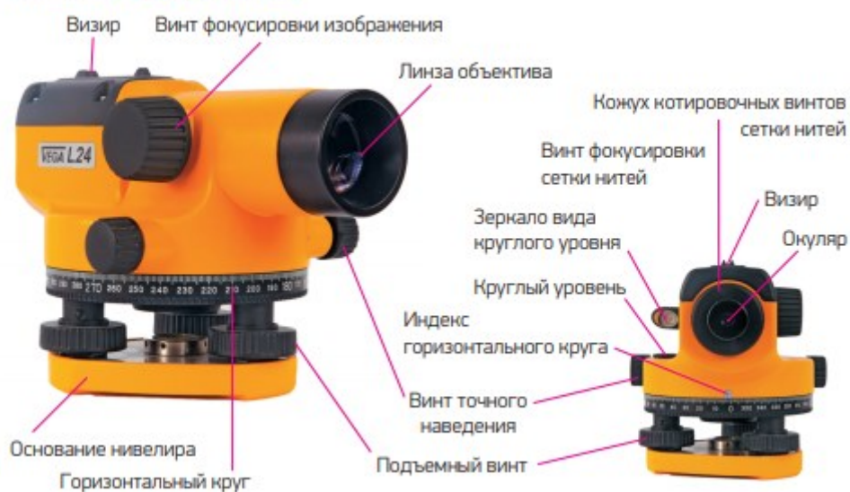
Рисунок 21. Устройство нивелира VEGAL24.
