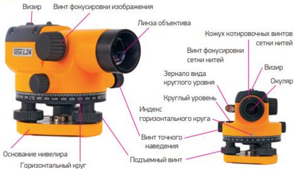
Рисунок 21. Устройство нивелира VEGAL24.
