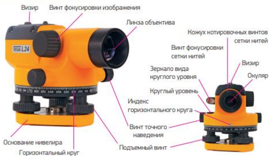
Рисунок 21. Устройство нивелира VEGAL24.
